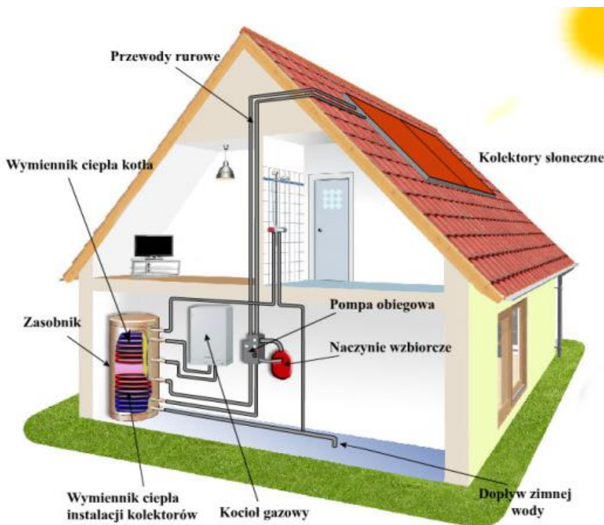
Ryc. 11. Schemat instalacji kolektorów słonecznych w domu jednorodzinnym
